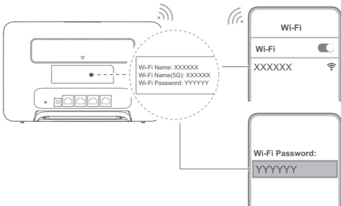
След като рутерът се свърже с мобилна мрежа за данни, можете да свържете компютъра или мобилния си телефон с Wi-Fi мрежата на рутера, за да имате достъп до интернет.
